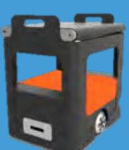
Los Sistemas de Clasificación Autónoma utilizan una flotilla de robots móviles configurables (Rovers) para clasificar paquetes. Los Rovers navegan desde el área de entrada hasta su destino de clasificación asignado con una mínima interacción humana, proporcionando una solución flexible, dinámica y de bajo riesgo.
